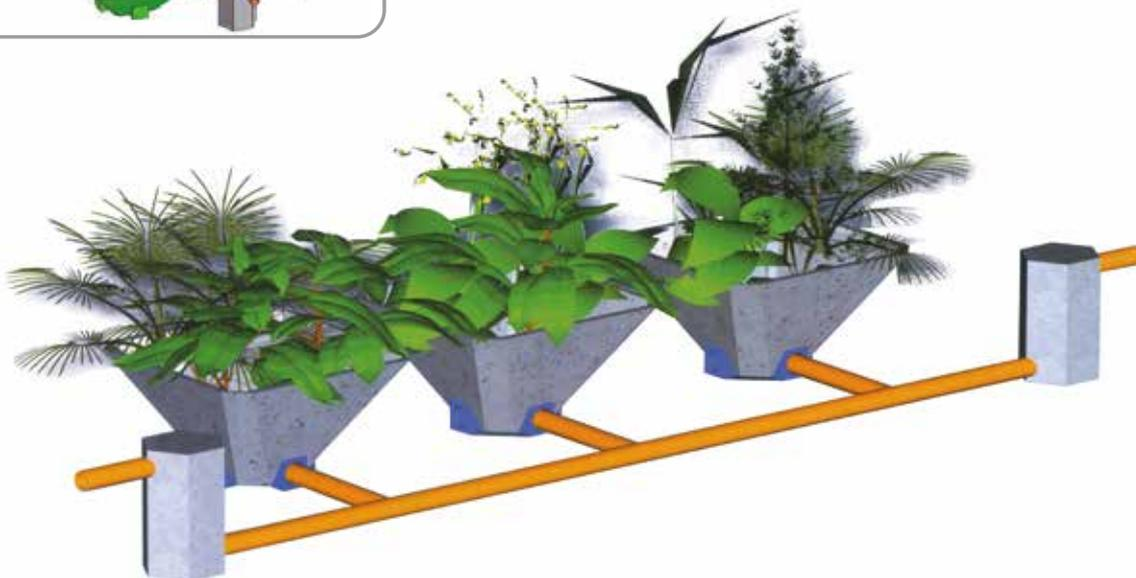
E' un'impianto per lo smaltimento di acque reflue pretrattate provenienti da civili abitazioni composto da vassoi assorbenti a pianta poligonale realizzati in polietilene lineare rotostampato.
